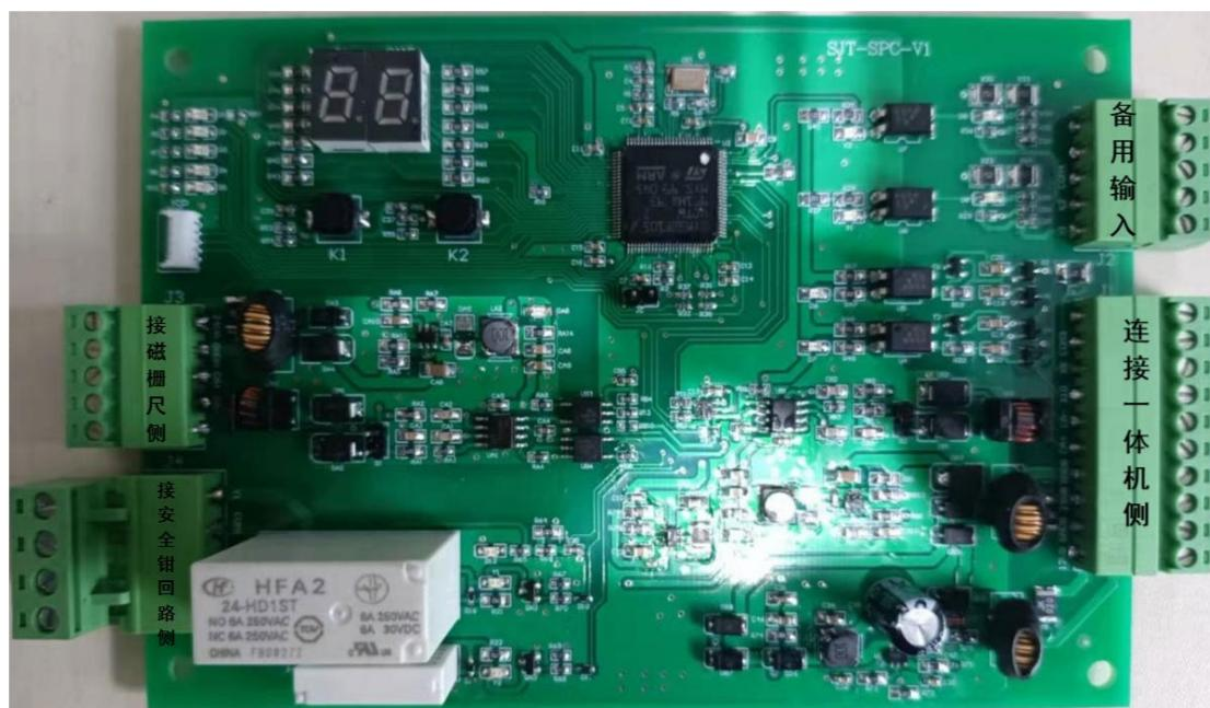
图 2 绝对位置控制板实物图
